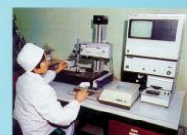
英国引进的泰勒索夫轮廓仪 Talor Contourgraph from UK
