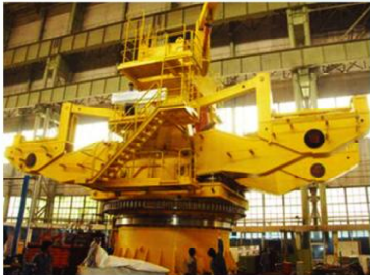
LYC 公司生产的目前国内最大的转盘轴承--外径 6250mm LYC made the largest slewing bearing out dia 6250mm in China
