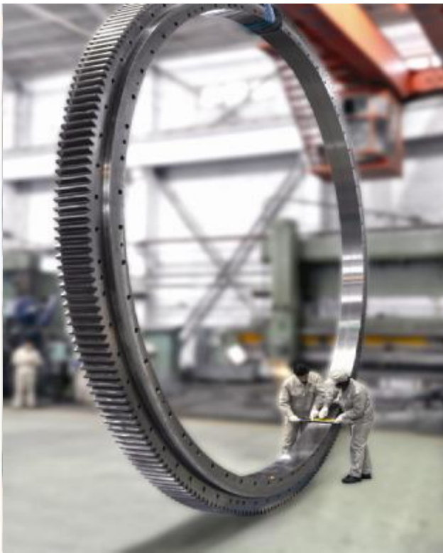
LYC 公司生产的目前国内最大的转盘轴承--外径 6250mm LYC made the largest slewing bearing out dia 6250mm in China
